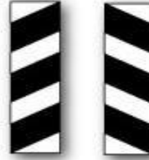
(T-31a,b) KÖPRÜ YAKLAŞIMI (Sağ, Sol)
