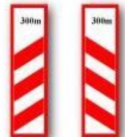
(T-28a,b) DEMİRYOLU HEMZEMİN GEÇİT YAKLAŞIMI (Sağ, Sol)
