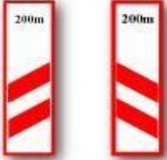
(T-29a,b) DEMİRYOLU HEMZEMİN GEÇİT YAKLAŞIMI (Sağ, Sol)
