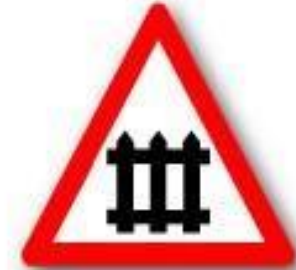
(T-25) KONTROLLÜ DEMİRYOLU GEÇİDİ
